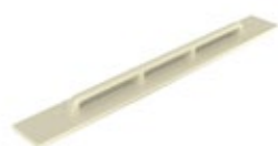
Långskånka. Används för att jämna av putsytan.
